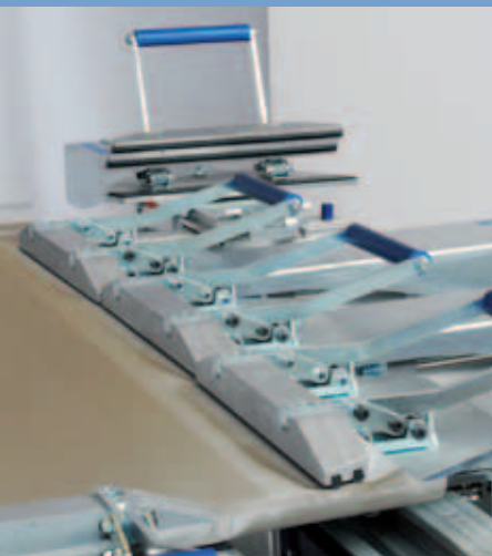
Kluppenbreite 250 mm mit Hub 100 mm Clamp width 250 mm with stroke 100 mm
