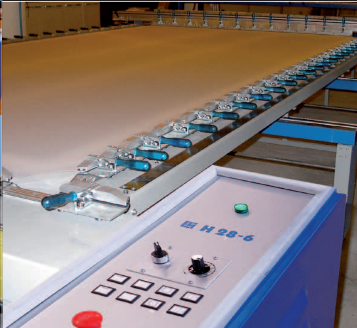
Elektronische Bedieneinheit mit Funktionstasten Electronic control unit with switches
